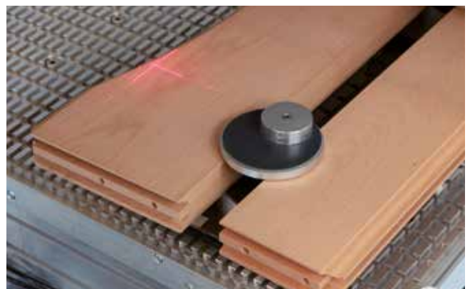
Laserpositionering De te frezen contour kan door de draadkruislasers worden gevolgd
