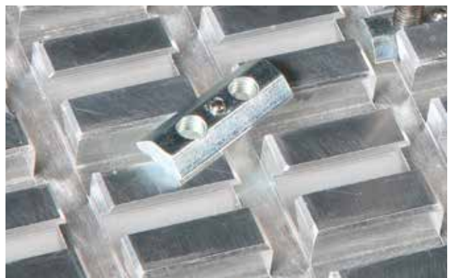
T-gleufmoeren met schroefdraad voor vormsluitende fixatie van spaninrichtingen in de zwaluwstaartgeleiding
