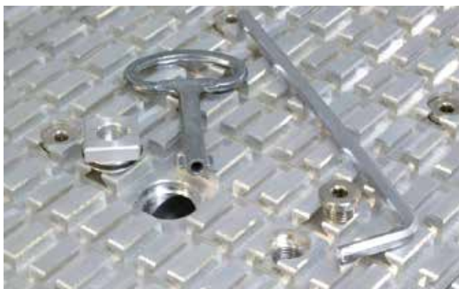
1" vacuümaansluitingen met snelle opening door middel van schakelkast sleutel, vacuümonderdelen met fijne schroefdraad voor het bevestigen van spanmiddelen
