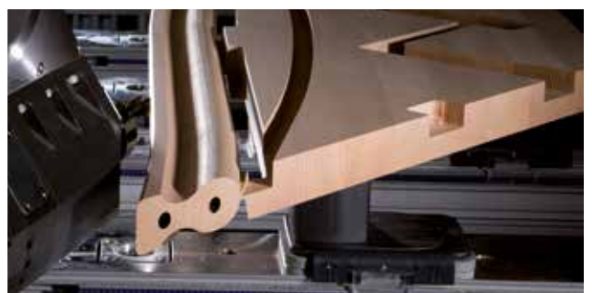
Staketboringen in een kleine hoek
