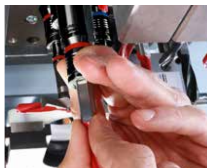
Gepatenteerd snelwisselsysteem voor het vervangen van boren zonder gereedschap voor kortere insteltijden.
