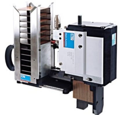
Autotec mit Wechselkassette für Heftklammern Autotec with change over cassette for staples
