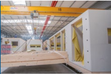
Die Module werden bereits in der Halle komplett vorgefertigt.
