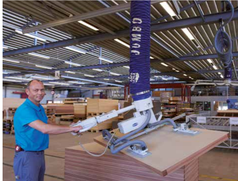
Dank der vier Greifpunkte wird das Vakuum des Schlauchhebers optimal auf die schwere Massivholztür übertragen
