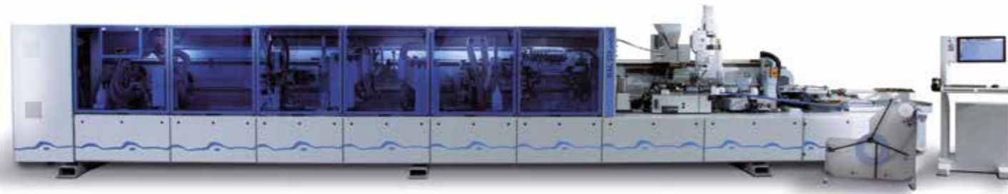
HOMAG KAL 370 und KDF 650 mit PU-Schmelzgerät von Balti
