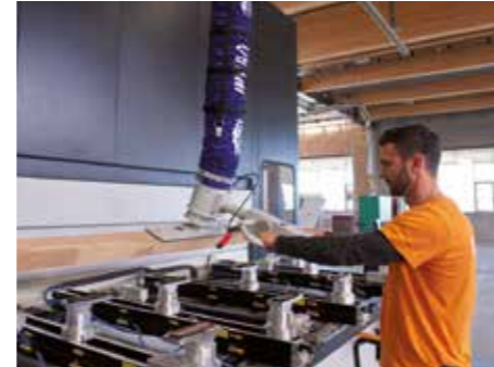
Auch beim Beschicken einer CNC-Bearbeitungsmaschine mit Türrahmen setzen die Mitarbeiter bei Brunegg auf Vakuum-Schlauchheber von Schmalz.
