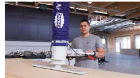
Für Türen mit normalem Gewicht ist ein JumboErgo mit einem Sauggreifer ausreichend
